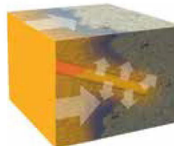
3) 使用PENETRON澎内传防水涂料 (PNC401) 涂覆墙面。新晶体会快速在墙壁的内部和外部同时生成。
