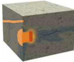
3) 使用 PENEKRETE MORTAR 澎内传修补砂浆 (PNC302) 填充裂缝和补平剩余孔洞部位。
