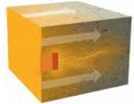
4) 使用 PENETRON 澎内传防水涂料 (PNC401) 涂覆。结晶技术可提供长久的防水保护。
