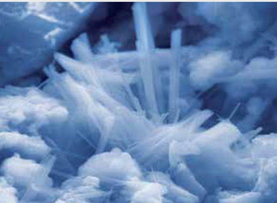
PENETRON 澎内传中的活性成分催化混凝土中的水泥水化产物反应后形成的结晶体照片，这些晶体结构可填充和封堵宽度达 0.5mm 的裂缝、孔洞和空隙。（放大倍数5000x）
